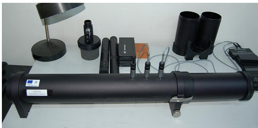
Obr. 3 Impedančná trubica Bruel &Kjaer typ 4206
