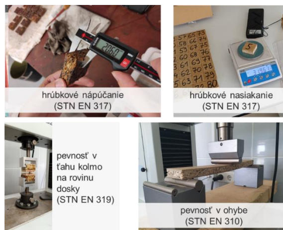
Obrázok 2 meranie vybraných fyzikálno-mechanických vlastností trojvrstvej drevoplastovej dosky Zdroj: vlastné spracovanie
