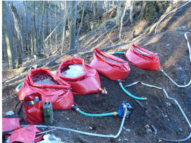
Obrázok 6.4 Jazierkový systém dopravy vody (Zdroj: MPH, 2007)
