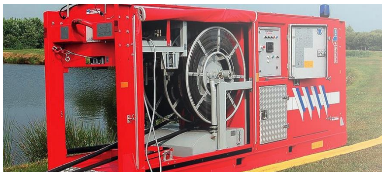
Obrázok 6.5 Systém vysokokapacitného čerpania vody (HYTRANS) (Zdroj: Pyronova, 2016)
